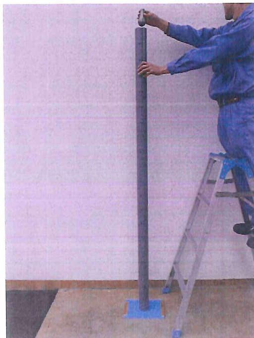
写真 3. 落球衝撃試験状況
